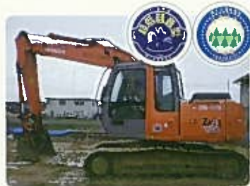
防音対策重機(低騒音車)
